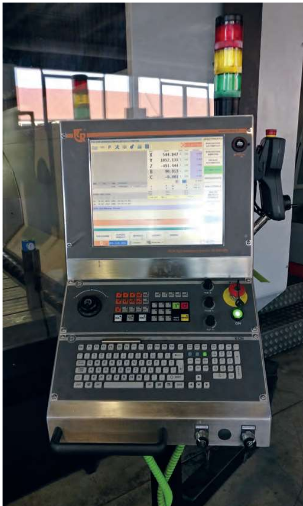
Il controllo numerico Z32 di D.Electron installato sul centro GS 2000 TT di RCR.
